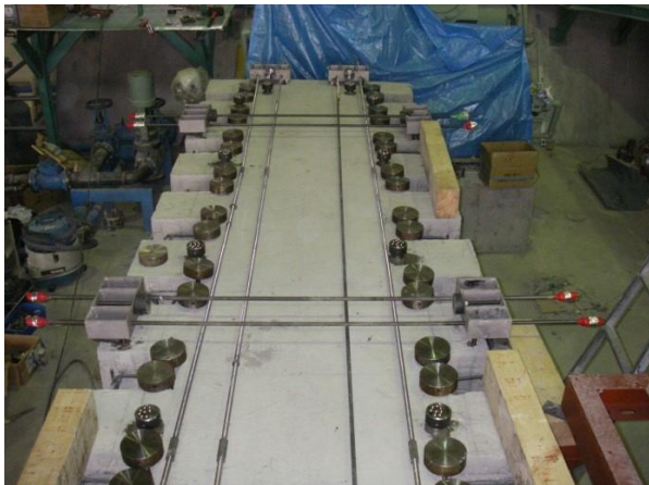
9.5 tonエンジン用にアンカー体型ライナーを配置
