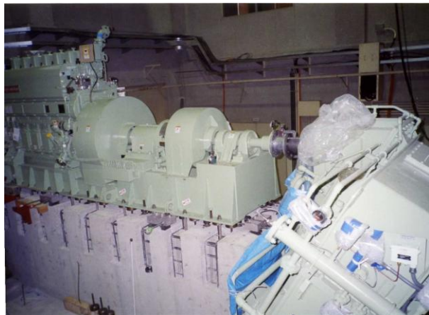
200psエンジンと減速機の調整状況（芯だし所要時間を50%に低減）
