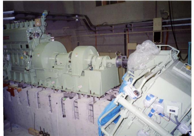
200ps 发动机和减速器的调整状况 (定心所需时间减少50%)
