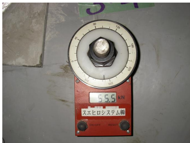
<地脚螺栓拔出试验>
