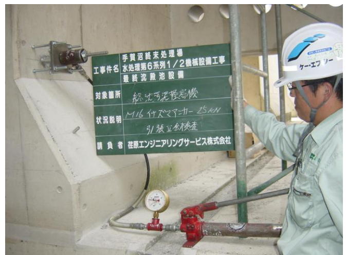
<拔出载荷 25KN 无异常>
