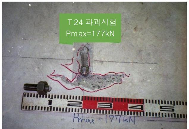
M12~M24 선단시험, 인발시험 결과 전부 볼트부가 파단(검사수 30)
